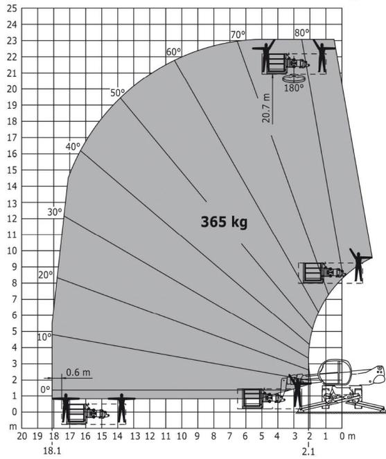
Machine sur stabilisateurs abaissés avec nacelle 1000 kg
