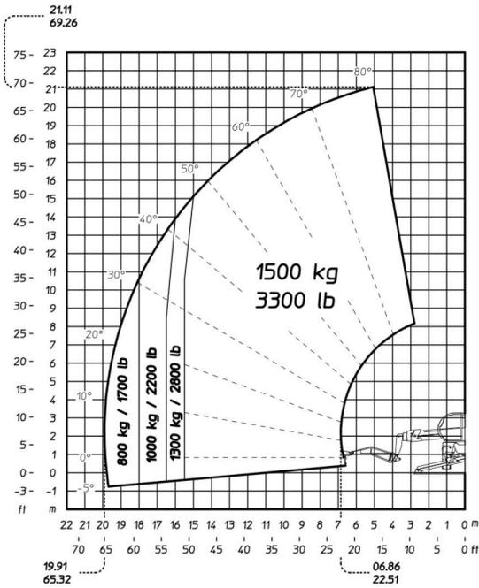
Machine sur stabilisateurs abaissés avec nacelle 365 kg
